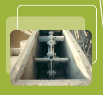
Destiné au transport « en masse » de pulvérulents, le transporteur à chaînes permet de grandes longueurs de transports, avec des produits chauds ou à grosse granulométrie.
